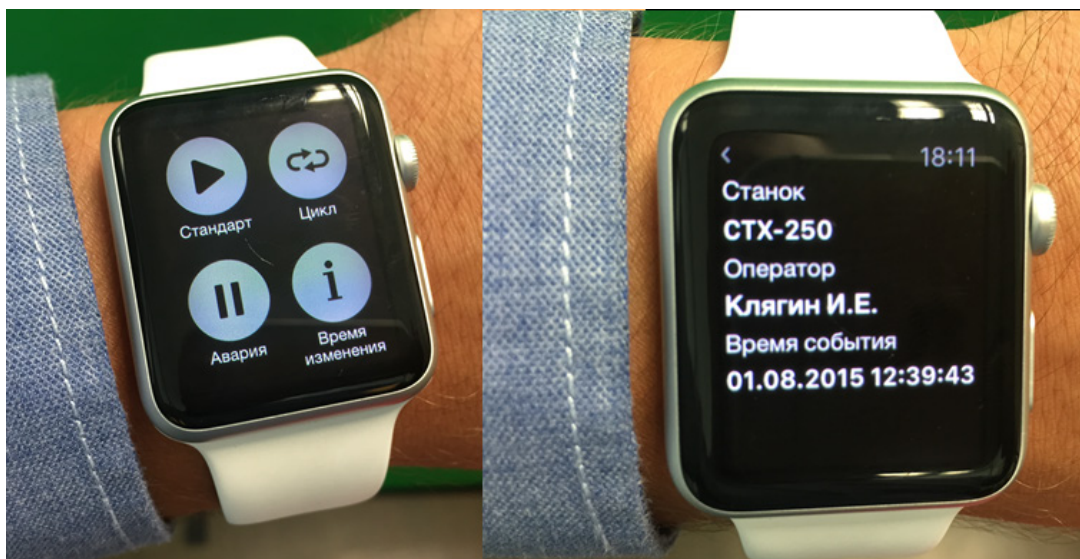
ЭКРАНЫ APPLE WATCH С ВЫБОРОМ СПОСОБА СОРТИРОВКИ СОБЫТИЙ (СЛЕВА) И ДАННЫМИ ОБ ОПЕРАТОРЕ И ТЕКУЩЕМ ПРОИЗВОДСТВЕННОМ ЗАДАНИИ (СПРАВА).
